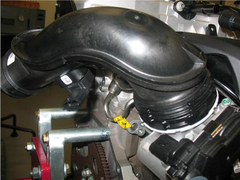
6. Apriete la abrazadera a 4 NM (35 lbs pulg.) una vez que el tubo/manguera suministrados por el cliente estén en su lugar. Este tubo viene del Enfriador de aire de carga provisto por el cliente.
