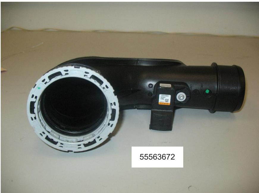
5. Instale el tubo de salida del enfriador de aire de carga en el cuerpo del acelerador. El tubo del enfriador de aire de carga está equipado con un collar de bloqueo. Gire el collar del enfriador de aire de carga en sentido de las manecillas del reloj para asegurar el tubo del enfriador de aire de carga en su lugar.
