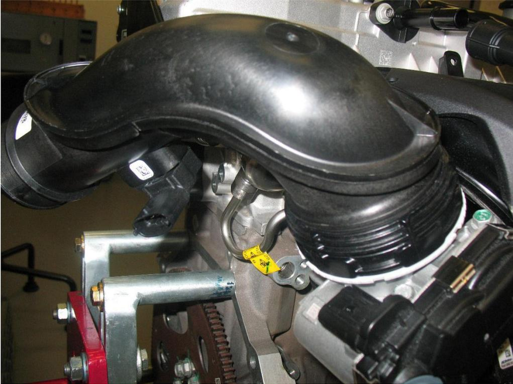
6. Serrer le collier de serrage à 4 NM (35 lb-po) une fois que le flexible/tube fourni par le client est en place. Ce tube provient du refroidisseur d'air de suralimentation fourni par le client.
