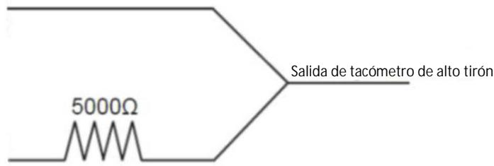
Ignición de clavija L de conector de mampara
