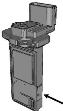
Souder le bossage en place avant de poser le débitmètre. Une fois posé dans le véhicule, le capteur de débit d'air massique (MAF) doit être monté avec l'extrémité du connecteur dirigée entre l'horizontale et la verticale – ne pas le monter avec le connecteur orienté vers le bas.
