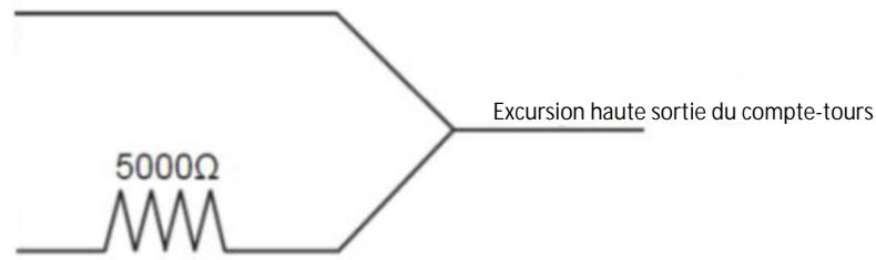
REMARQUE : lorsqu'il est branché au faisceau de câbles du système « Connect and cruise » Supermatic de CHEVROLET PERFORMANCE, le contrôleur de boîte de vitesses ne requiert aucune résistance à excursion haute.
