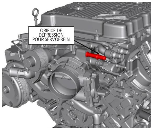
Un orifice est prévu à l'avant du moteur pour la dépression du servofrein. Le moteur LT5 pourrait ne pas produire une dépression adéquate pour assurer le bon fonctionnement des servofreins dans toutes les conditions. Différentes configurations de pompes à dépression électriques sont disponibles chez votre concessionnaire local. Veuillez examiner les pièces de rechange de la Corvette ZR1 2019 pour les pièces supplémentaires.
