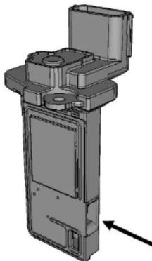
Suelde el cubo en su lugar antes de instalar el sensor. Cuando se instala en el vehículo, el sensor de flujo de aire másico (MAF) se debe instalar con el extremo del conector apuntando entre la horizontal y completamente vertical – no instale con el sensor orientado hacia abajo.
