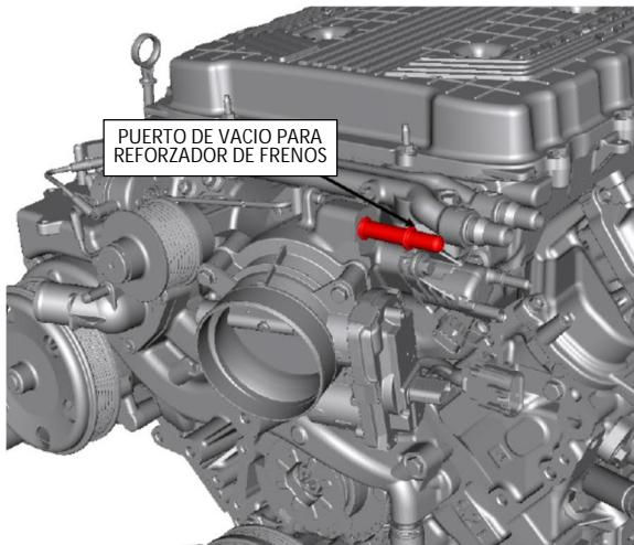
Un puerto en el frente del motor está disponible para el vacío del freno de potencia. El motor LT5 puede no producir vacío adecuado para asegurar la operación adecuada de los frenos de potencia bajo todas las condiciones. Varias configuraciones de bomba eléctrica de vacío diferentes están disponibles a partir de su concesionario local. Por favor vea las partes de servicio Corvette ZR1 2019 respecto a partes adicionales.
