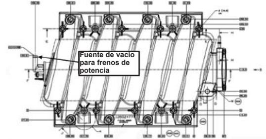
**Fuente de vacío de refuerzo del freno de potencia**
