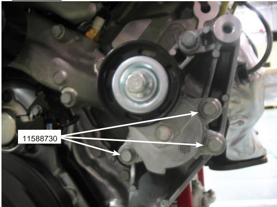
12. Instale las poleas de SC (12642706 y 12678515) como se muestra en la Figura 13 y apriete a 58 NM (43 PIES LB)
