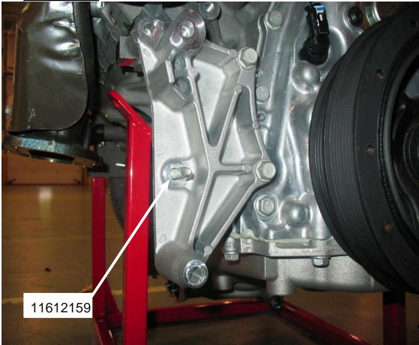
4. Poser le tendeur de courroie de climatiseur (12686272) avec 1 boulon (11588730) et 1 boulon (11518694), comme indiqué sur la figure 5 – Serrer à 22 Nm (16 pi-lb) :
