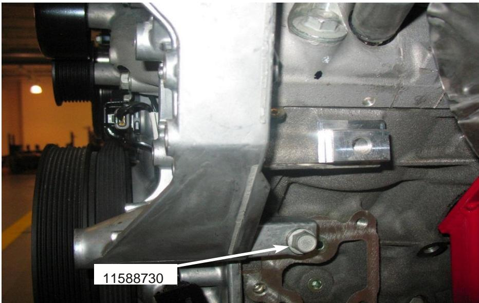
11. Poser le tendeur de compresseur de suralimentation avec 3 boulons (11588730), comme indiqué sur la figure 12 – Serrer à 25 Nm (18 pi-lb) :
