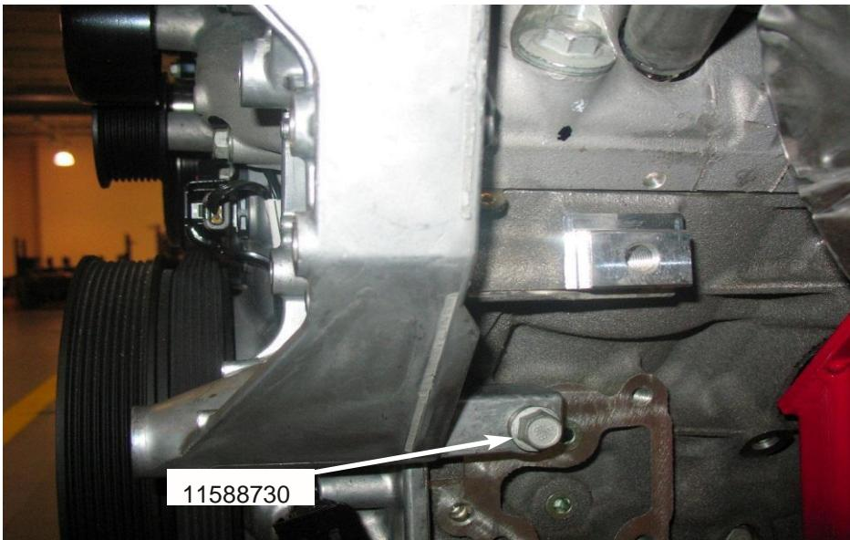
11. Instale el tensor del SC con 3 pernos (11588730) como se muestra en la Figura 12 - apriete a 25 NM (18 PIES LB):
