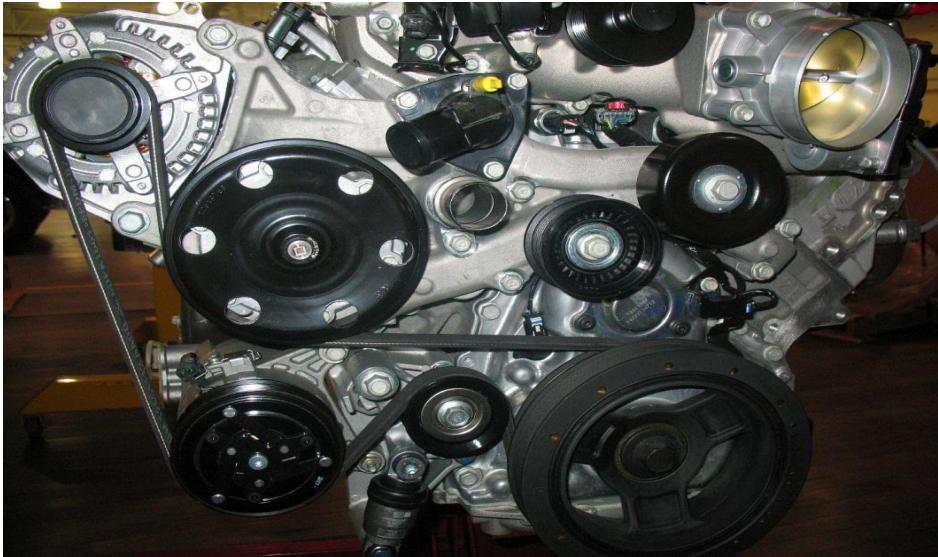
8. Instale la polea intermedia del Súpercargador (12678295) y la polea de SC (12642706) como se muestra en la Figura 9 - apriete a 58 NM (43 PIES LB):
