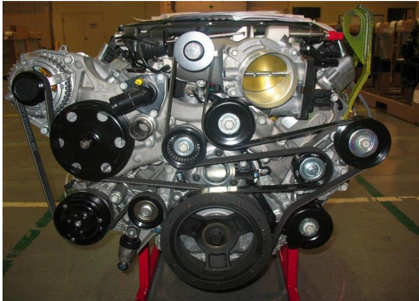
1. Instale el soporte, número de parte (12639512) usando 2 de los pernos (11588730) como se muestra en la Figura 2 - Apriete a 22 NM (16 PIES LB):
