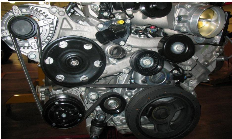
8. Poser le galet-tendeur de compresseur de suralimentation (12678295) et la poulie de compresseur de suralimentation (12642706), comme indiqué sur la figure 9 – Serrer à 58 Nm (43 pi-lb) :
