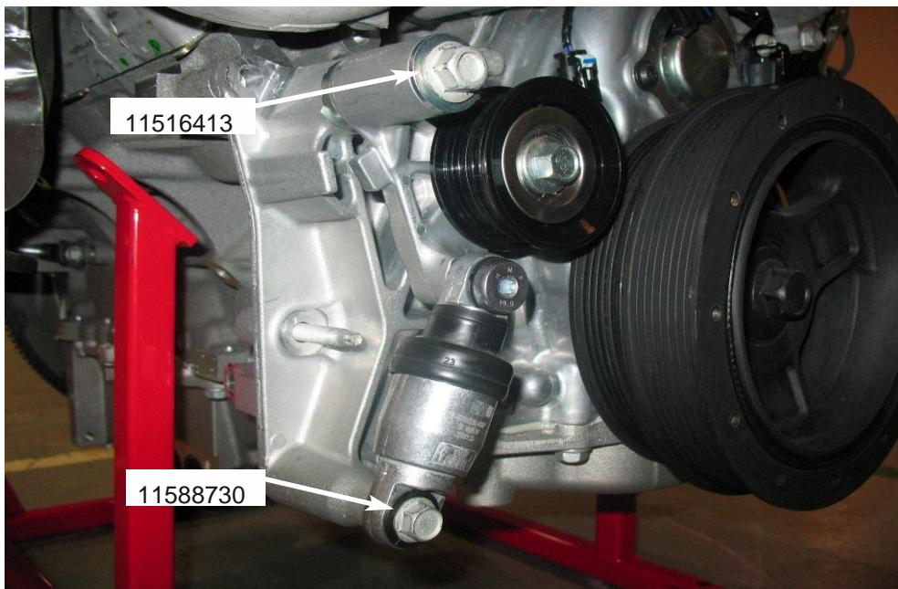
5. Poser le compresseur (23370609) de la façon indiquée avec le boulon (11588694) et l'écrou (11610091), comme indiqué sur la figure 6 – Serrer à 22 Nm (16 pi-lb) :
