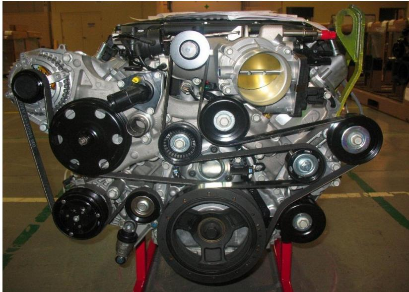
1. Poser le support, numéro de pièce (12639512) avec 2 boulons (11588730), comme indiqué sur la figure 2 – Serrer à 22 Nm (16 pi-lb) :
