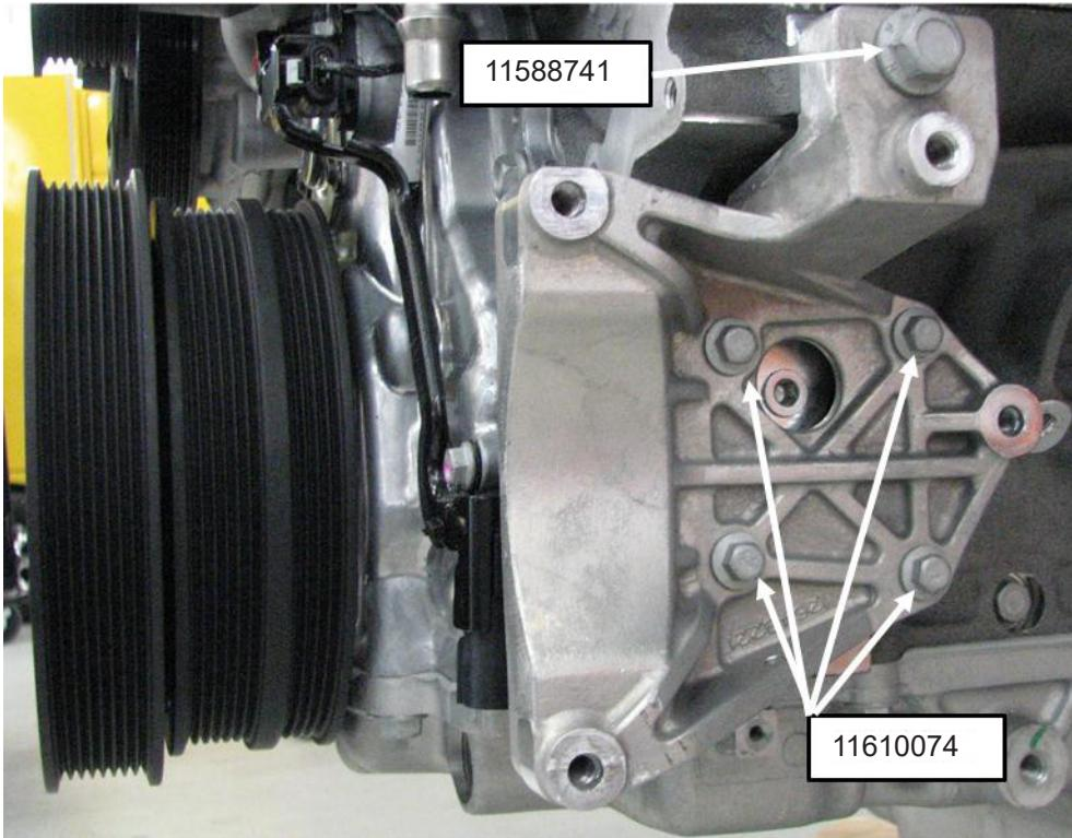
2. Poser le goujon 11561137 comme illustré à la figure 3. Serrer au couple de 8 NM (71 LB-PO). Fixer le compresseur de climatisation 84313365 au support du moteur avec les boulons 11588732 et 11588735 comme illustré aux figures 3 et 4. Serrer l'écrou 11514596 au couple de 22 NM (16 LB-PI). Serrer les boulons 11588732 et 11588735 au couple de 25 NM (18 LB-PI).
