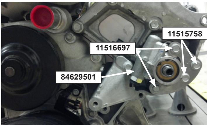
4. Installer la poulie de pompe 12568997 de P/STG sur la pompe à l'aide d'un outil de pose de poulie de pompe de direction assistée (non compris). Le numéro de pièce de la poulie figure à l'opposé de la pompe Positionner la poulie de manière à ce que le flanc extérieur du moyeu soit aligné avec l'extrémité de l'arbre de la pompe. Se reporter aux figures 3 et 4 ci-dessous.
