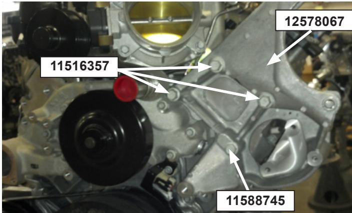
3. Installer la pompe 84629501 de P/STG et le tasseau 12555693 sur le support 12578067 à l'aide des boulons 11516697 (2) et 11515758 (2) tel qu'ilustré à la figure 2 ci-dessous.
