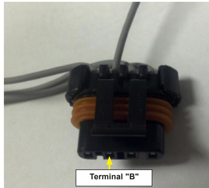
Retire el conector del generador original del arnés del motor LSA de Chevrolet Performance Parts y empalme el cable de la cavidad "B" en el conector 15306009 en el cable naranja del arnés del motor LSA. Otros cables del conector no se utilizan.
