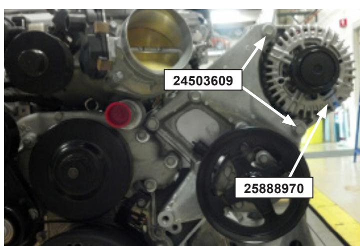
**NOTA:** La parte posterior del generador está muy cerca de la bobina de ignición #1 sobre el LSA. ¡Puede necesitar modificar el montaje de la bobina para tener espacio!
