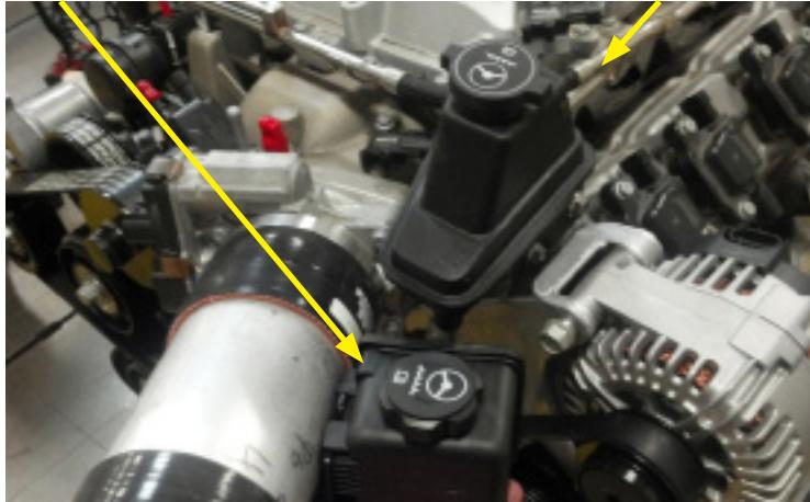
También se puede usar el montaje de la defensa interna. Se debe colocar más arriba de la bomba. No se incluye la manguera del depósito a la bomba en este juego. Se debe obtener localmente.
