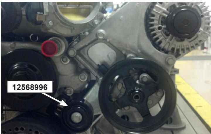
**Installation du tendeur, de la poulie et de la courroie**
