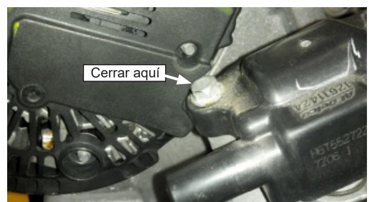
6. Instale la polea intermedia de la banda 12568996 sobre el soporte 12578067 con el perno prisionero.
