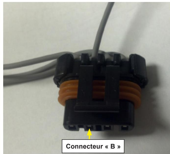
Retirer le connecteur d'alternateur d'origine du faisceau de câblage de moteur LSA Chevrolet Performance Parts et procéder à l'épissage du fil de la cavité « B » du connecteur 15306009 avec le fil orange du faisceau de câblage du moteur LSA. Les autres fils du connecteur ne sont pas utilisés.
