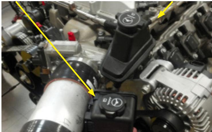
Le montage à l'intérieur de l'aile peut aussi être utilisé. Doit être positionné plus haut que la pompe. Le tuyau reliant le réservoir à la pompe n'est pas compris dans ce nécessaire. Il doit être obtenu sur place.
