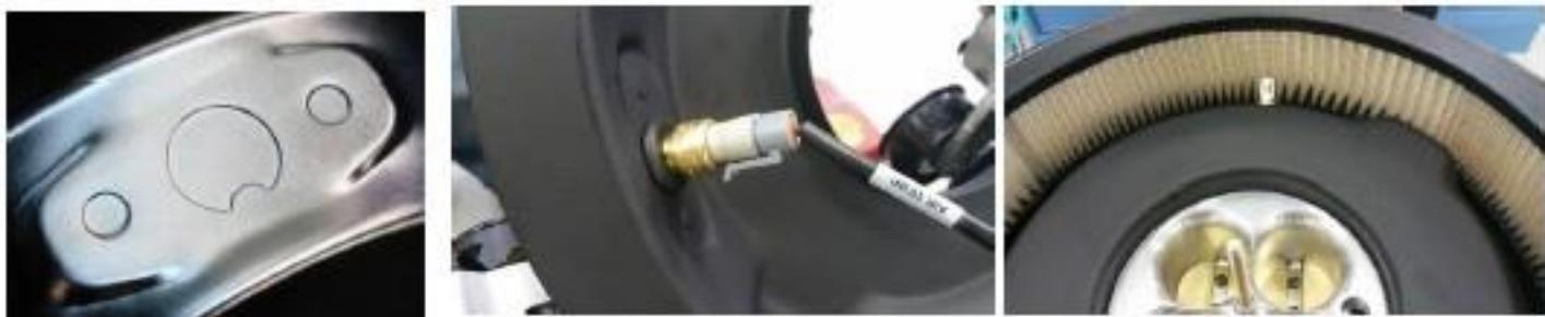
Dans la base du purificateur d'air, qui est un composant inclus dans la trousse du purificateur d'air ZZ6 fournie avec l'ensemble « clé en main » ZZ6, (1) retirer le panneau rond formé, (2) insérer le passe-fil en caoutchouc fourni et (3) installer le capteur MAT dans le passe-fil. Connecter le fil, étiqueté « Air Temp » (température d'air), entre le faisceau de câbles et le capteur MAT, comme indiqué ci-dessus.
