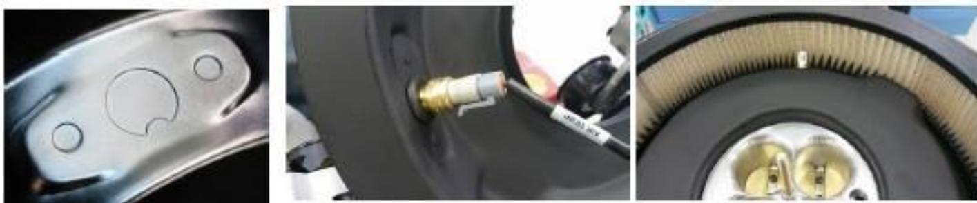
En la base del filtro de aire, que es un componente incluido en el juego del depurador de aire ZZ6 suministrado con el paquete "Llave en mano" ZZ6, (1) retire el tablero redondo formado, (2) inserte el pasacables de hule suministrado y (3) instale el sensor MAT en el pasacables. Conecte la terminal de cable, etiquetada "Temperatura de aire", del arnés de cableado al sensor MAT como se muestra anteriormente.
