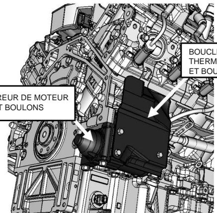
BOUCLIER THERMIQUE ET BOULONS
