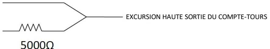
**REMARQUE :** lorsqu'il est branché au faisceau de câbles du système « Connect and cruise » Supermatic de GMPP, le contrôleur de boîte de vitesses ne requiert aucune résistance d'excursion haute.
