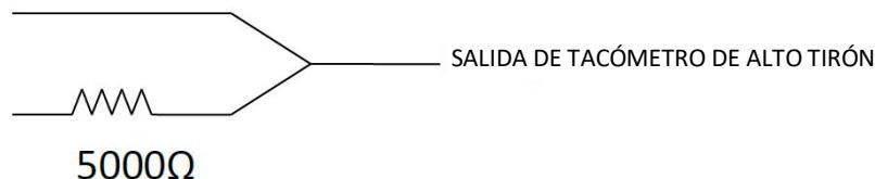
**NOTA:** Cuando se conecta al Arnés de conexión y crucero Supermatic GMPP no se requiere el resistor de elevación para el Controlador de transmisión.
